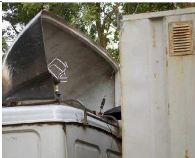
В обоих случаях антенна установлена так, что сзади и значительно выше нее расположены металлические каркас или металлический корпус пластикового кузова. Кроме того, в последнем случае произведена установка еще и на рейлинг! Маловероятно что там есть масса. Качеству связи можно только посочувствовать! В МАЗы, КАМАЗы настоятельно рекомендуем врезать антенны в крышу.
