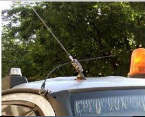
На водостоке стоит антенна для магнитолы. Врезана в крышу антенна рации. В данном случае то, что они касаются друг друга (даже при отсутствии электрического контакта) может сильно ухудшить настройку ОБЕИХ антенн. Видимо, антенна для магнитолы все время падала, и водитель решил так ее закрепить. Прием магнитолы наврядли заметно стал хуже, т.к. в черте города магнитола ловит на выкинутый проводок на улицу, а вот рация потеряла процентов до 30-40 дальности.
