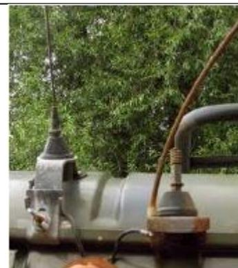
Поэтому, желательно при смене сезона (т.е. 2 раза в год) производить осмотр и профилактику системы: зачищать разъемы, крепления, подкручивать разъемы, прозванивать кабель и т.д. Если этого не делать, то в какой-то момент падает дальность и качество, а радика сгорает, хотя изначально настраивали и делали все по правилам.
