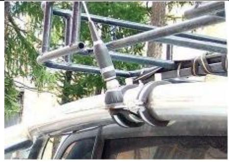
Массы изначально нет в обоих случаях. Слева установка на пластик, на фото справа антенна установлена на специальные изолирующие прокладки. Однако, для контакта с землей проброшена массовая жила (белый кабель) и данная проблема устранена.
