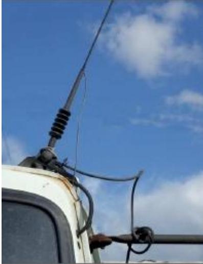
Эта ф-я - вершина курьеза! Антенна для магнитолы. Мало того, что на антенну навязаны какие-то крючки (т.е. она служила стойкой), избыток кабеля обмотан вокруг металлического сердечника (стойка зеркала бокового вида), так еще и к антенному штырю прикреплен кабель, соединенный с корпусом машины! Не возможно даже предположить, какую идею воплощал пользователь антенны, и на какое чудо рассчитывал.
