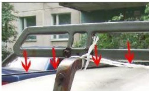
Антенны, зажата крышкой багажника и привязанная веревкой к багажнику на крыше. А кроме того, грубая ошибка заключается в том, что штырь не должен касаться ничего металлического. Если электрический контакт есть, то это КЗ на массу, если нет (как слева) - то это сильная расстройка КСВ и сильное изменение ДН (диаграммы направленности).
