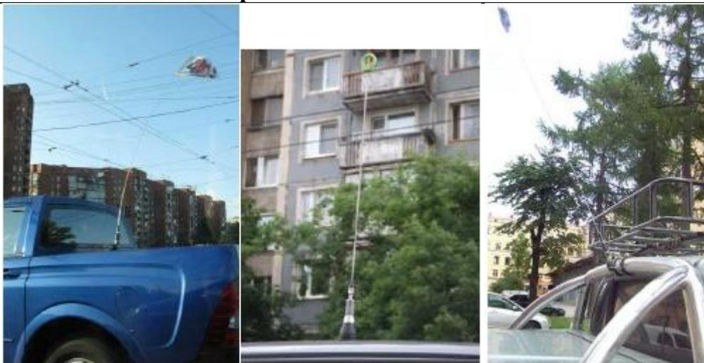
Украшение гибкой антенны различными предметами приводит к увеличению парусности и в результате инерционности. Антенна раскачивается сильнее, чем без нагрузки. За счет такого колебания во время движения меняется КСВ. При некоторых установках колебания КСВ происходят от 1 до 10. В таком случае рация - кандидат на сгорание, не говоря о качестве и дальности связи.
