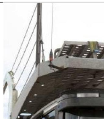
Антенна на рацию установлена вплотную к металлическим частям кузова, поэтому ксв антенны в районе 5-6.
