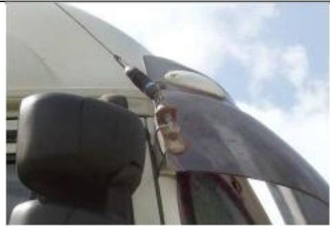
Автомобиль IVECO (евростар или евротеК). Слишком большой наклон антенны. На этом месте массу можно получить путем зачистки в нужных местах. Изначально на пластике ее нет.
