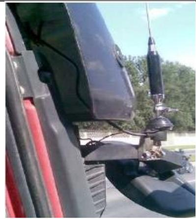
Автомобиль Iveco Stralis. Антенна установлена на крепление зеркала (пластик). Кинута массовая жила на болт. Правильнее было бы установить антенну в штатное место под козырек, которое находится в 20 см от зеркала. Когда антенну можно поставить без массовой жилы, нужно ставить без нее. В данном примере жила очень тонкая и длинная.
