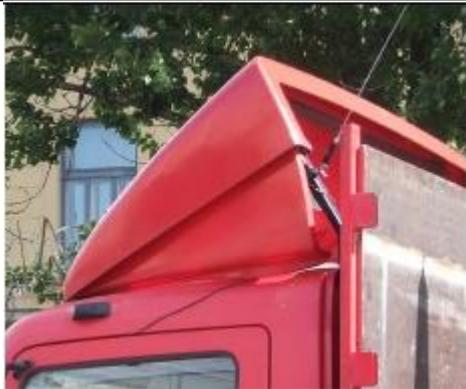
Такие решения - один из классических вариантов установки с абсолютным непониманием как работает антенна. Многие думают, что ее просто нужно к чему-нибудь прикрутить. Как правило, рейлинги не имеют контакта с массой (но бывают исключения). В случае, если кронштейн имеет контакт с рейлингом, а рейлинг не имеет контакта с массой, то рабочей (подстилающей) поверхностью антенны является только рейлинг.
