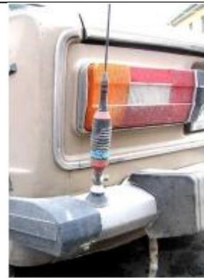
Антенна 27 МГц. Отсутствие "земли", экранирование стенкой багажника сводят "на нет" выигрыш от применения хорошей длинной антенны Alan 9 Plus.
