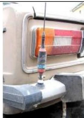
Антенна 27 МГц. Отсутствие "земли", экранирование стенкой багажника сводят "на нет" выигрыш от применения хорошей длинной антенны Alan 9 Plus.
